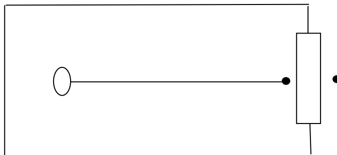
图 4.2.3-1 室内声源等效为室外声源图例
