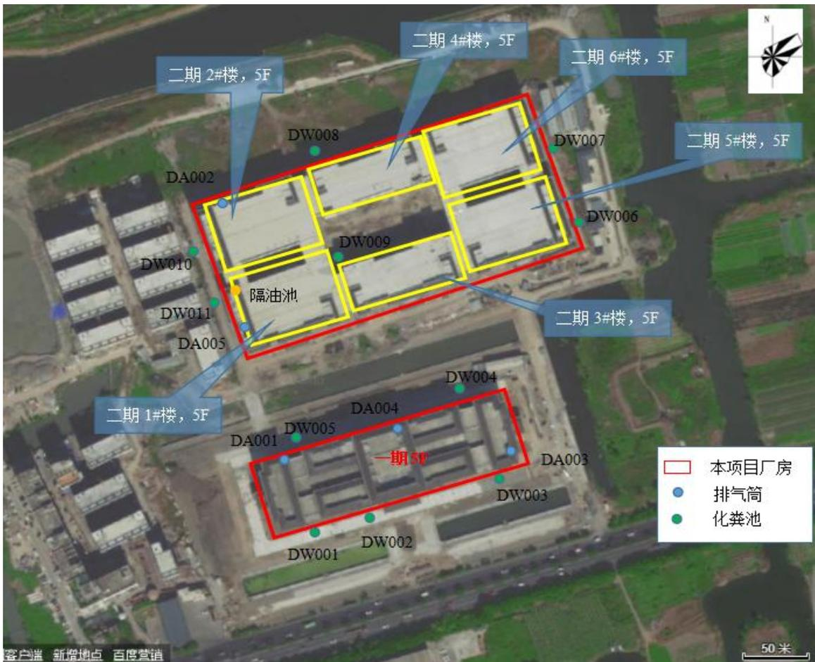
注：具体布置以后期实际为准，DA001、DA002 排气口为移印废气排放口；DA003 排气口为擦拭废气排放口；DA004 排气口为激光打标、点焊、锡焊废气排放口；DA005 排气口为食堂油烟排放口。DA001、DA004、DA005 为现有排气口。
