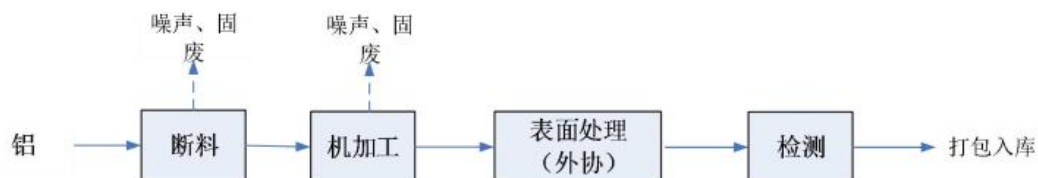
图 2-5 各类阀门气缸连接件工艺流程示意图
