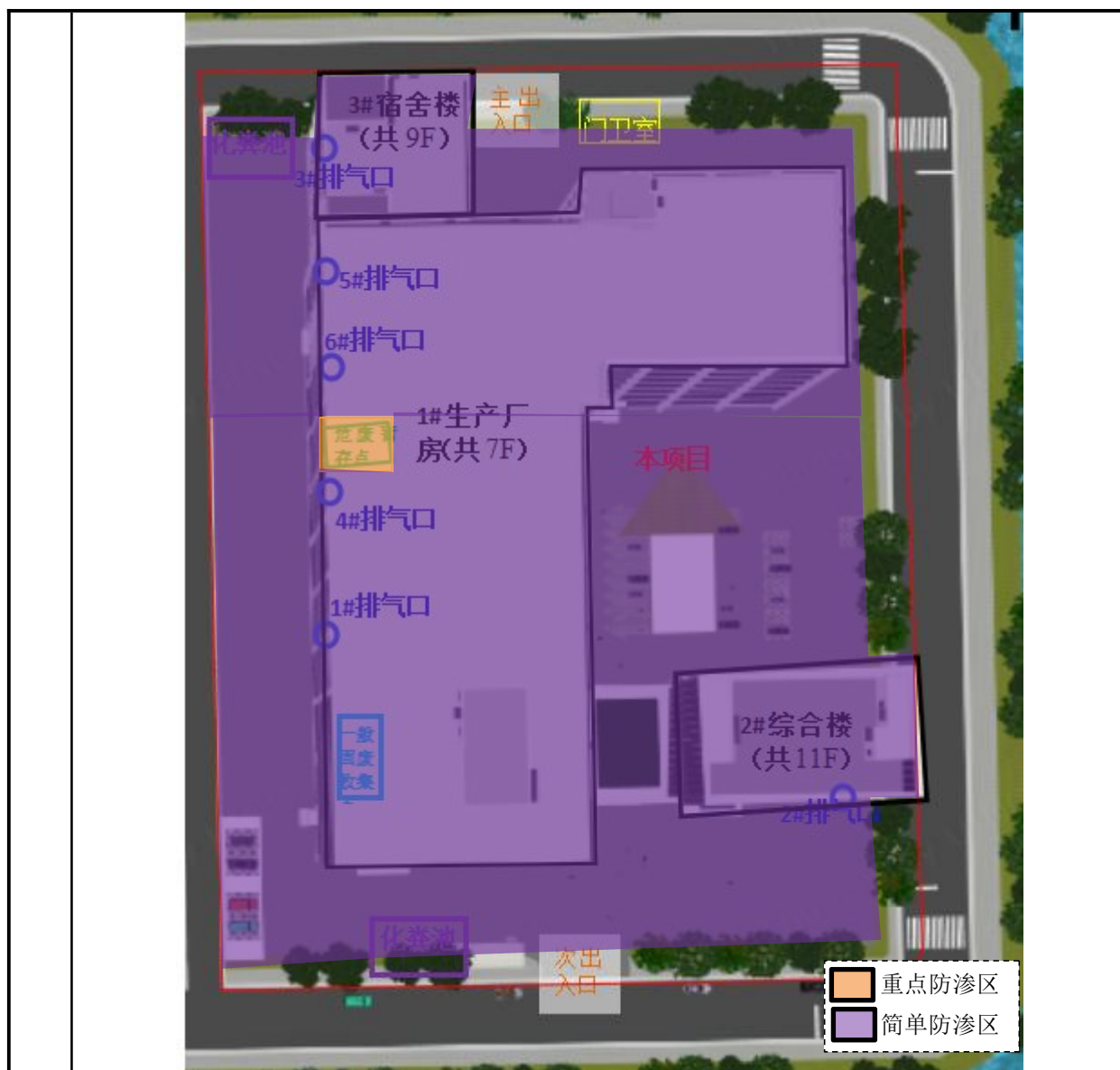
图 4-1 项目厂区地下水污染防治分区图
